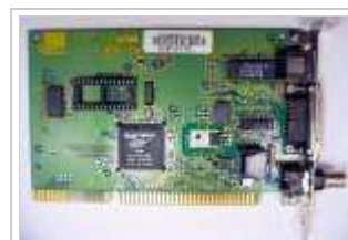
Tarjeta de Red ISA de 10Mbps con conectores RJ-45, AUI y 10Base2.
